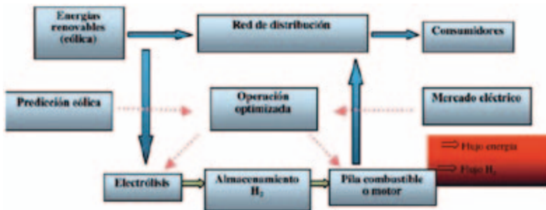
Figura 14. Sistema energético integrado en la red eléctrica.
